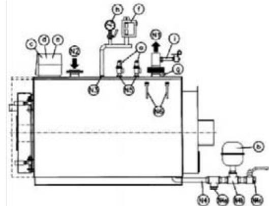
Убедитесь, что гидравлическое давление в системе, замеренное после клапана-редуктора на линии подачи воды в агрегат, не превышает показателя рабочего давления, указанного в табличке изготовителя котла.
