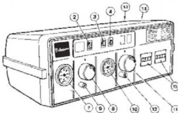
Верхняя крышка корпуса пульта управления снимается для облегчения доступа к контактной шине и для продевания проводов от термостатов и термометров. Внутри корпуса находится также копия схемы электрооборудования.
