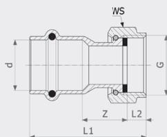
**Переход на резьбовые соединения Profipress G**
