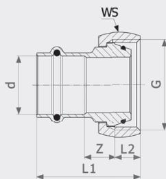
**Переход на резьбовые соединения Profipress G**
