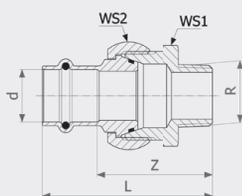
**Соединительный элемент резьбовой разъемный Profipress G**
