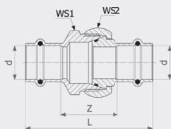
**Соединительный элемент резьбовой Profipress G**
