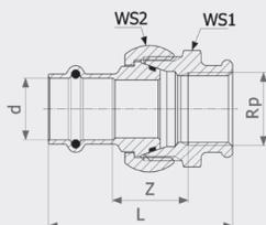
**Соединительный элемент резьбовой разъемный Profipress G**
