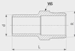
**Соединительный элемент Sanpress**
