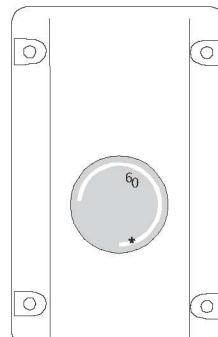
Задняя панель при использовании внешней регулировки температуры ГТВ
