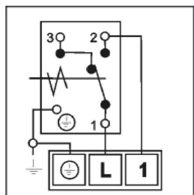
СХЕМА ПОДКЛЮЧЕНИЯ NTR 24 V
